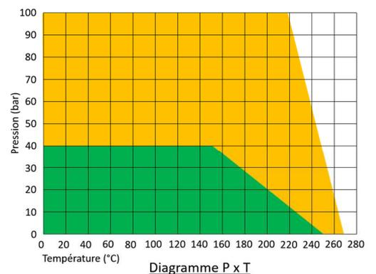
Ce diagramme précise les limites de service en tenant compte de l'influence simultanée de la Pression et de la Température (La compatibilité chimique étant supposée).
