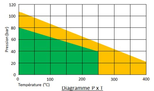
Ce diagramme précise les limites de service en tenant compte de l'influence simultanée de la Pression et de la Température (La compatibilité chimique étant supposée).
