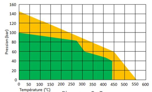
Ce diagramme précise les limites de service en tenant compte de l'influence simultanée de la Pression et de la Température (La compatibilité chimique étant supposée).
